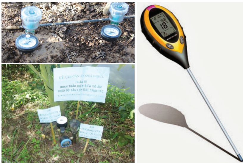
Hình 11. Tensiometer quan trắc độ ẩm đất
